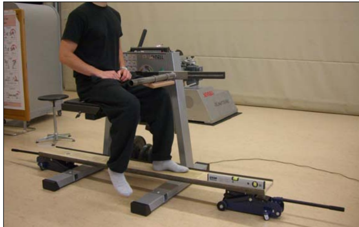
Abbildung 2: Messaufbau zur Bestimmung der isometrischen Maximalkraft am M3 Diagnos System, Fa. Schnell
